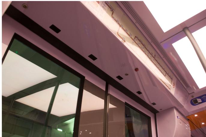
FIGURE 7: Capteurs présents au-dessus des portes de trains Z50000
